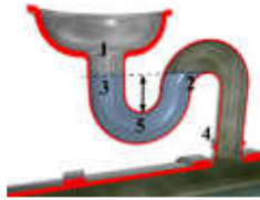
Fig. 2. Schéma d'un siphon d'évier. 2
