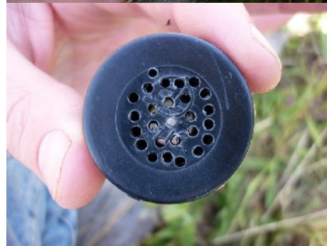
XXXX Photo A50 et A51 : Trous de 1 mm réalisés dans un bouchon de fin de ligne. Des trous de diamètre inférieur mériteraient d'être essayés pour avoir un jet plus fin et plus long.
