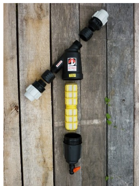
XXXX photo A43 : filtre à tamis représenté sur la figure 33. Le robinet à manivelle rouge en bas est une purge, à utiliser pour vider complètement le filtre par temps de gel.
